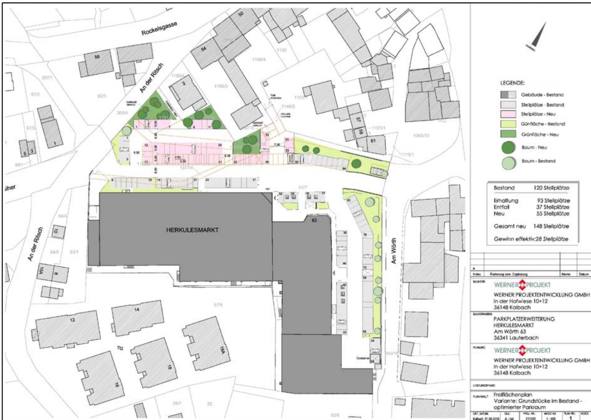
Abb. 6: Freiflächenplan: optimierter Parkraum
