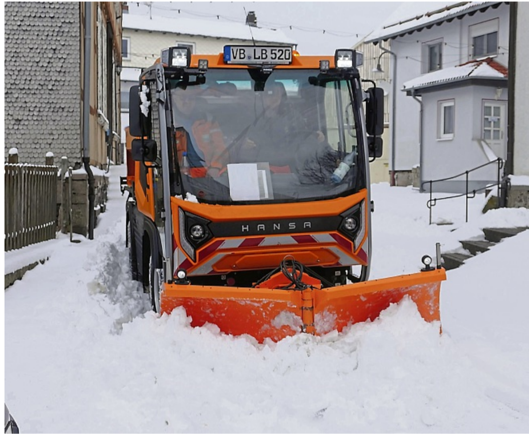
Tim Felix Müller wird vom erfahrenen Markus Krüger in Wallenrod mit den örtlichen Besonderheiten vertraut gemacht. Das Multifunktionsfahrzeug ist besonders wendig, das Räumwagenschild kann sowohl linear als auch in Pfeilform eingesetzt werden.
